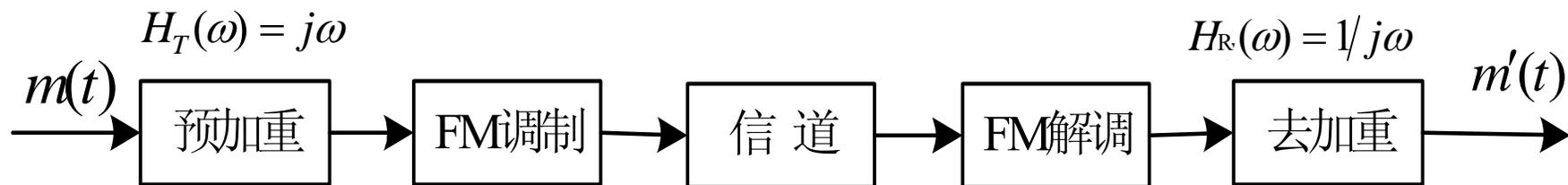
由前知，解调后输出的噪声功率正比于频率的三次方，是因为鉴频器的传输特性正比于频率的平方。添上一个随频率增加其传输特性滚降的线性网络 $H_R(f)$ 使解调器的传输特性趋于平坦，就能降低高频段的噪声。为了不至于造成失真，在发送端还应添上一个互补的予加重网络，只要使 $H_T(f) \cdot H_R(f) = 1$ 即可。
